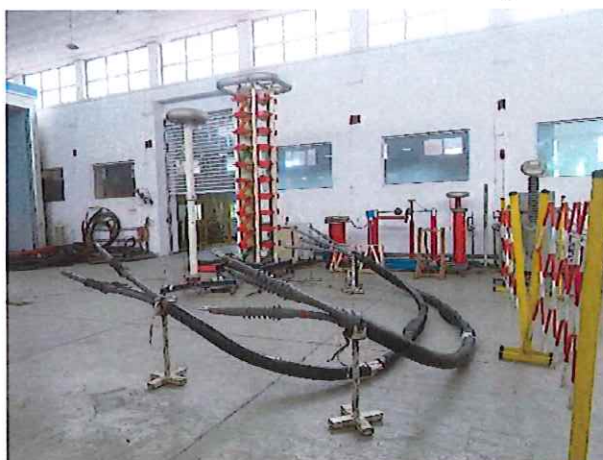
G3: 冲击电压试验 Impulse voltage test
