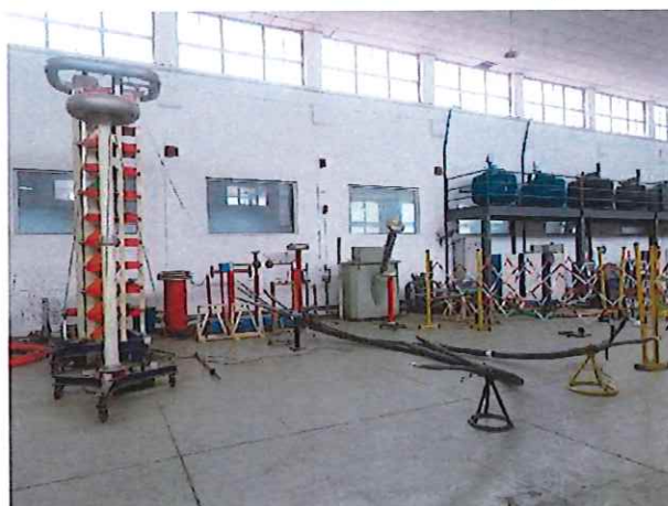
G3: 冲击电压试验 Impulse voltage test
